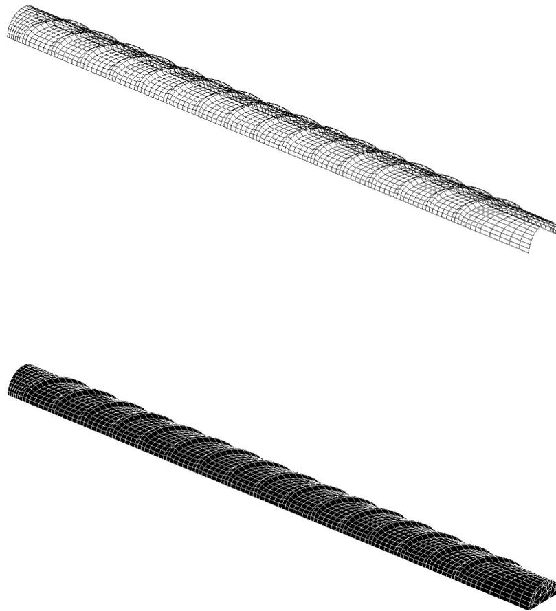
FIGURE 1.1 – Modèle de la barre d'acier haute adhérence
